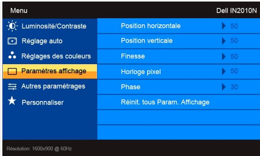
**H Position (Position horizontale)** Utilisez les boutons et pour ajuster l'image à gauche/droite. Le minimum est '0' (-). Le maximum est '100' (+).
